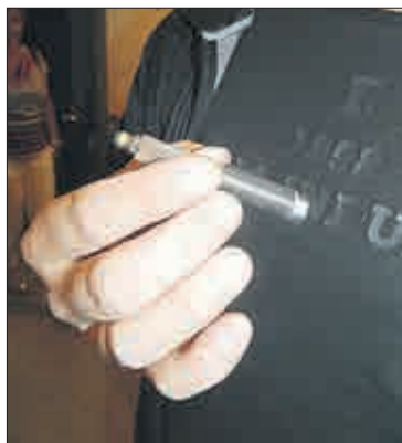
Injektážní hmoždinka – nedílná součást realizace technologie.
